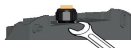
Afb. 6-15: Draai de kabelwartel aan de achterkant vast
