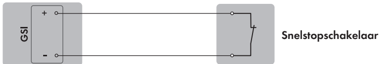
Afbeelding 11: Aansluiting van een schakelaar voor de snelstop op de digitale ingang GSI van de Sunny Boy Smart Energy die als System Manager moet worden geconfigureerd
